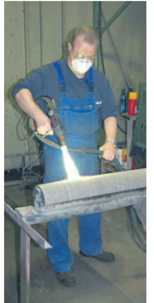
Hier werden die Teile für eine Spezial-Förderkette beschichtet.
