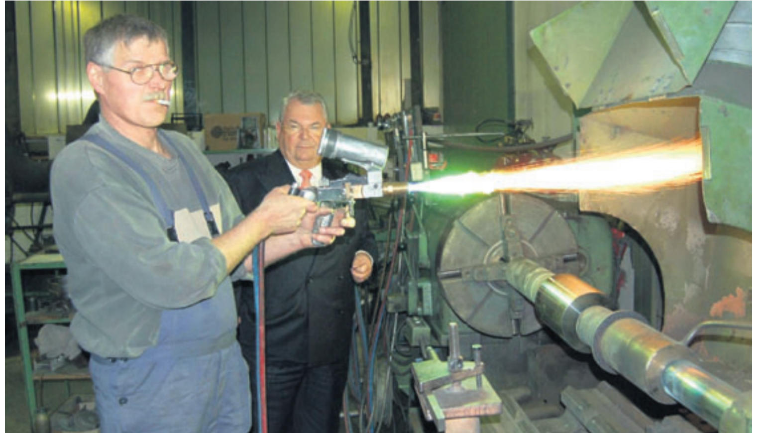
Mit einer speziellen Schweiß-Pistole schießt dieser Arbeiter Metallpulver auf das Werkstück. Otto Schrage (Hintergrund) hat 14 Patente und Gebrauchsmuster auf seine Erfindungen und schaut immer wieder in der Firma vorbei. FOTOS: HORST FREY
