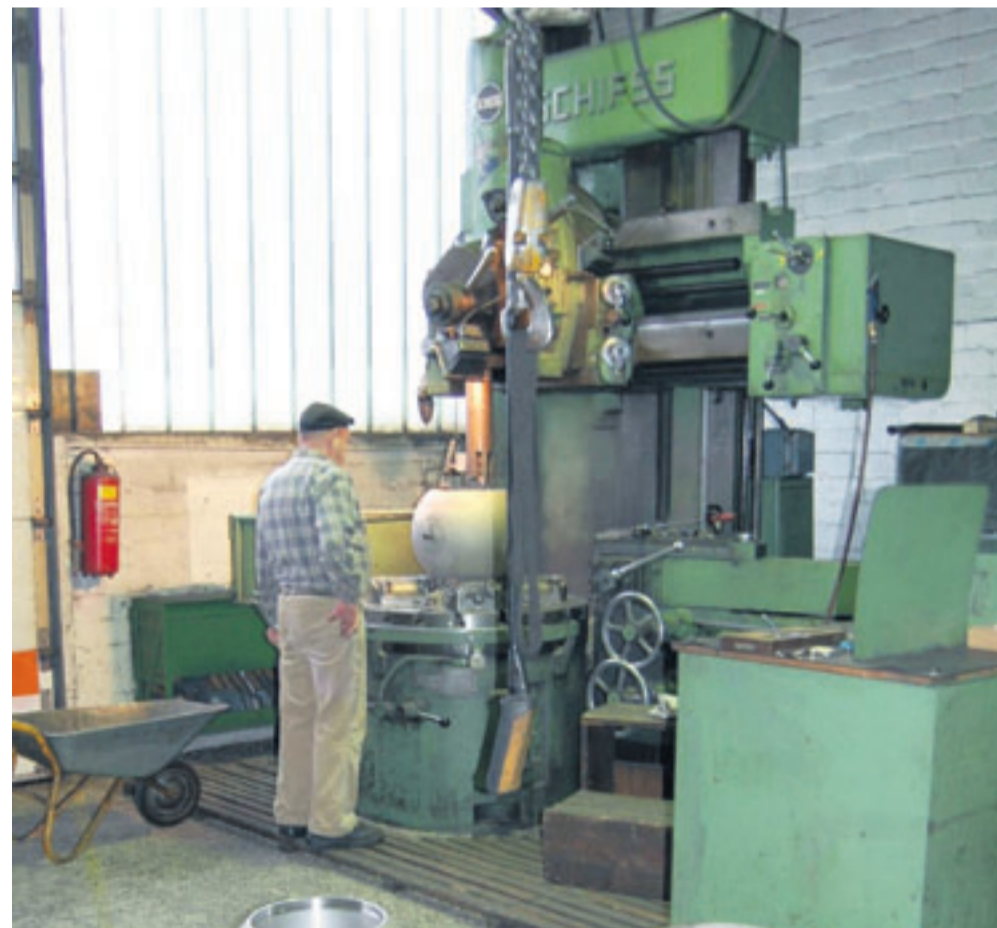
An dieser Spezialschleifmaschine wird ein Rundkörper für einen Kugelhahn geschliffen. Die Belastung dieser Kugeln ist gewaltig, deshalb müssen sie außerdem spezialbeschichtet werden.
